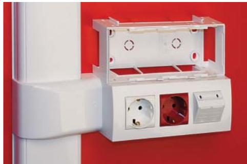
При помощи узких отводов (код 07211 для канала 70x22 мм и код 09211 для канала 90x25 мм), которые также используются для подвода к монтажным коробкам PDD-N (код 10123 и 10143), можно подсоединить коробку (код 09221 или 09231) при вертикальном расположении к кабель-каналу (см. на фото)
