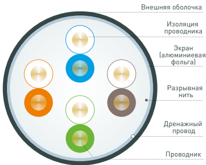
Рис. 2 – Конструкция кабеля F/UTP(количество жил 4x2)
