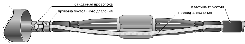
Рис. 1 Комбинированная система заземления
