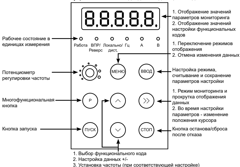
Рисунок 5 – Описание съемной панели управления VCI-KP
