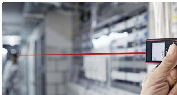
**Высокоточные лазерные дальномеры Navigator NMT-Dml01** предназначены для дистанционного измерения линейных расстояний, вычисления площадей и объемов помещения, а также для сложения и вычитания полученных данных.
