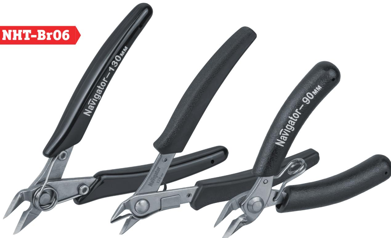
**Бокорезы Navigator NHT-Br06** используются для электромонтажных, электротехнических и радиотехнических работ, включающих резку медных и алюминиевых проводов, пластиковых хомутов. Бокорезы оснащены разжимной пружиной, что обеспечивает плавный рез с приложением минимальных усилий. Лезвия из японской нержавеющей стали с прецизионной шлифовкой режущих кромок гарантируют легкий качественный рез без деформации кабелей и проводов.
