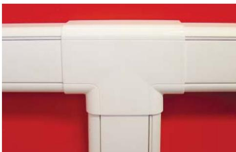
Установите защелкиванием накладку на тройник и крышки кабель-каналов, заведя их торцы под накладку тройника
