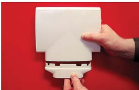
При отведении от прямой трассы широких коробов короба меньшего сечения нужно вставить под лицевую накладку тройника соответствующий переходник (140-110 мм, 140-90 мм или 110-90 мм)
