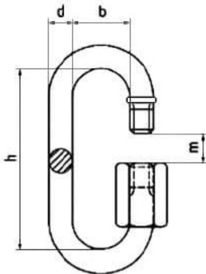
Карабин винтовой оцинкованный применяется для быстрого и надёжного соединения цепей и тросов. Не используется для подъема грузов.
