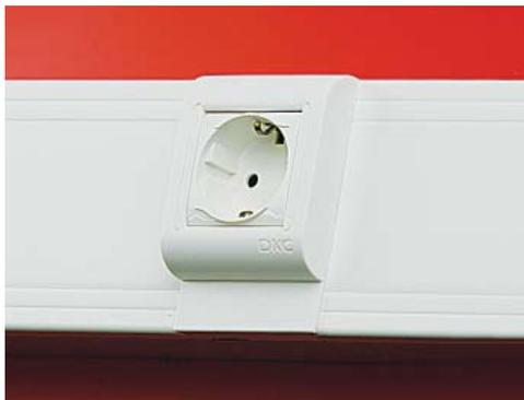
Монтаж закончен. Чтобы разобрать, необходимо немного отодвинуть крышку от рамки-суппорта и нажать на верхнюю или нижнюю защелку фиксатора рамки
