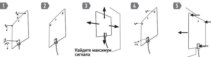
Установка на неметаллические поверхности
